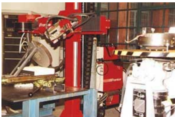
Abb.3 Versuchsaufbau für die Untersuchung verschiedenster schweißtechnischer Parameter
