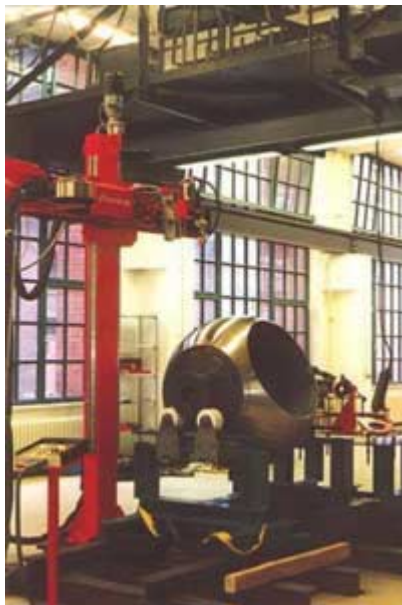
Abb.4 Automatisiertes Aufpanzern der Kugelhähne mit dem WIG-Heißdraht-Schweißverfahren schweißtechnischer Parameter
